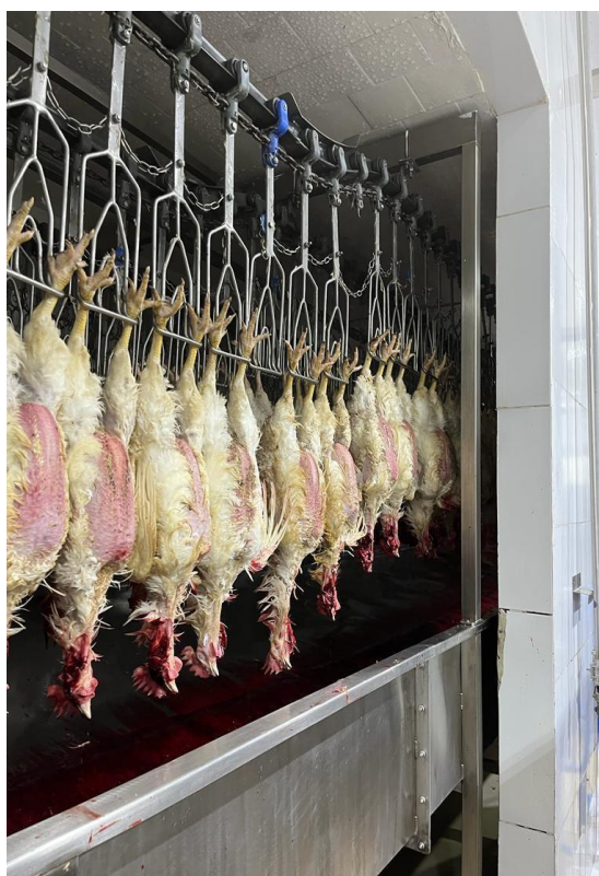
Figura 6 - Túnel de sangria
