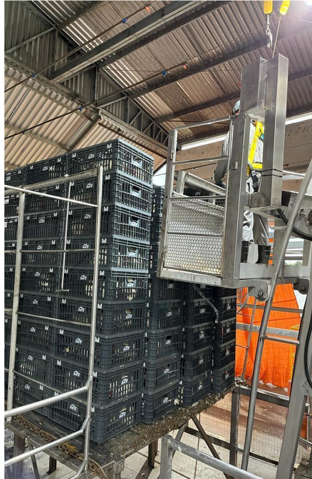
Figura 2- Retirada das gaiolas e dispendo na esteira
