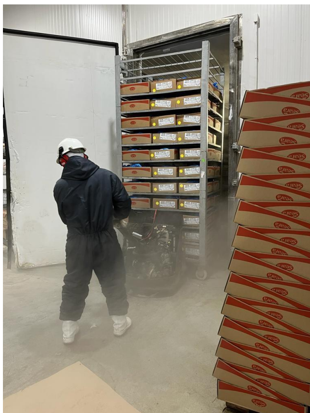
Figura 12 - Gaiolas sendo retiradas do túnel, pós congelamento
