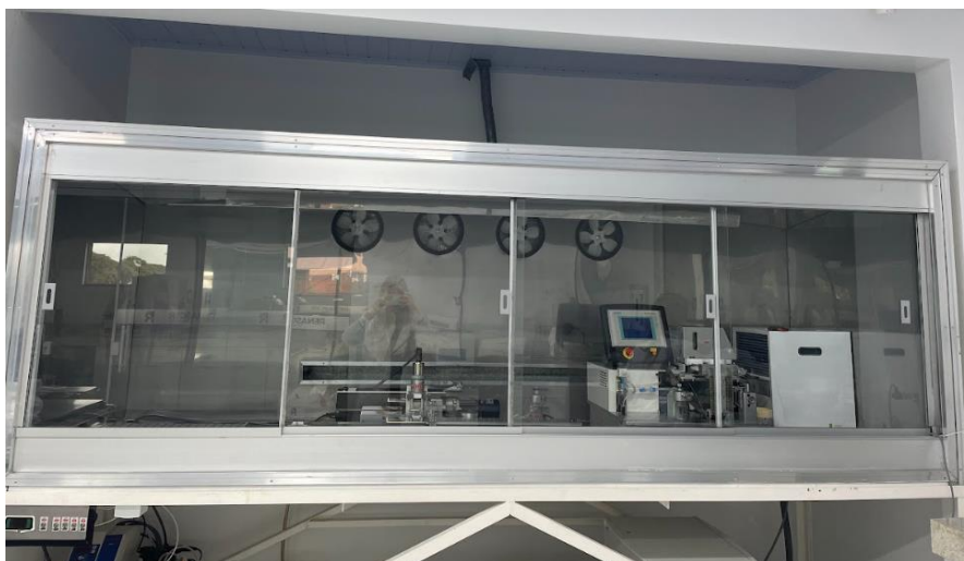
Figura 22 - Balcão refrigerador utilizado para realização do resfriamento do sêmen, no interior as envasadeiras MRS1 e MRS4
