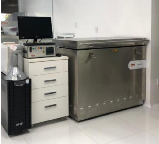
Figura 23 - Freezer de temperatura controlada para congelamento e sêmen, DigitCool® IMV Technologies.
