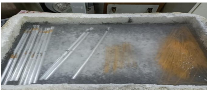
Figura 27 - Processo de raqueamento, onde palhetas e raques estão imersas em N2L.
