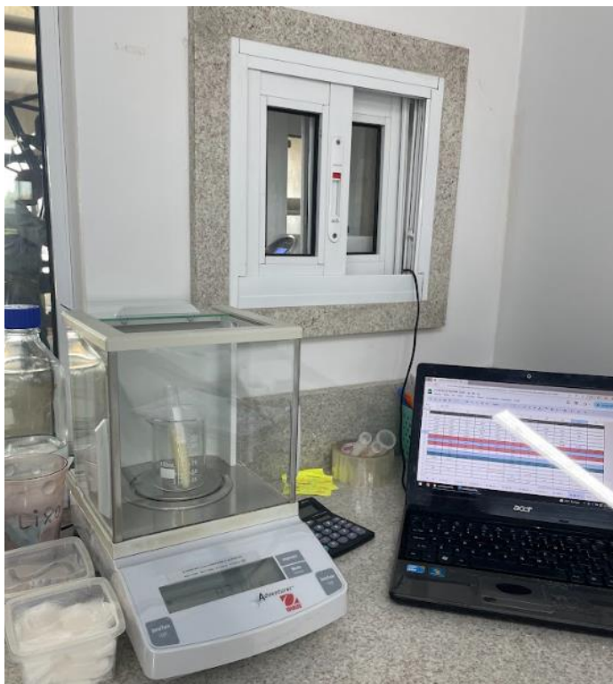
Figura 19 – Área de recebimento com balança analítica para mensuração do volume através do peso do ejaculado e ficha de controle.
