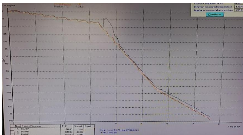
Figura 24 - Computador de comando onde se visualizar a curva de congelamento do freezer, com a temperatura teórica em amarelo, temperatura da câmara em vermelho e temperatura do produto em azul.
