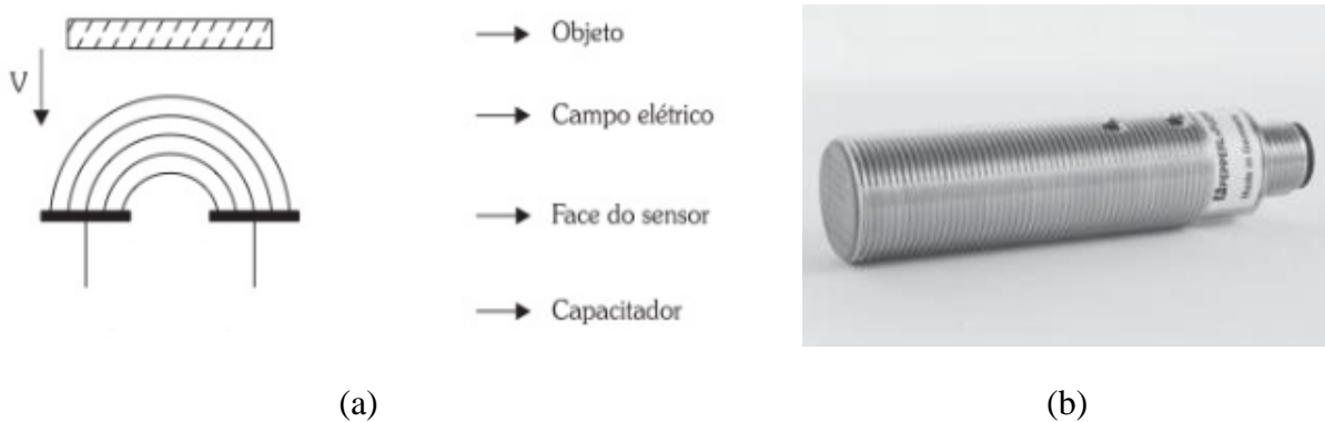
Figura 5 – Princípio de funcionamento do sensor capacitivo e seu design .
