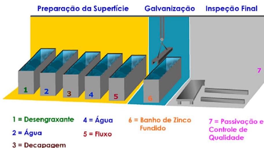
Figura 22 - Etapas do processo de galvanização a fogo.
