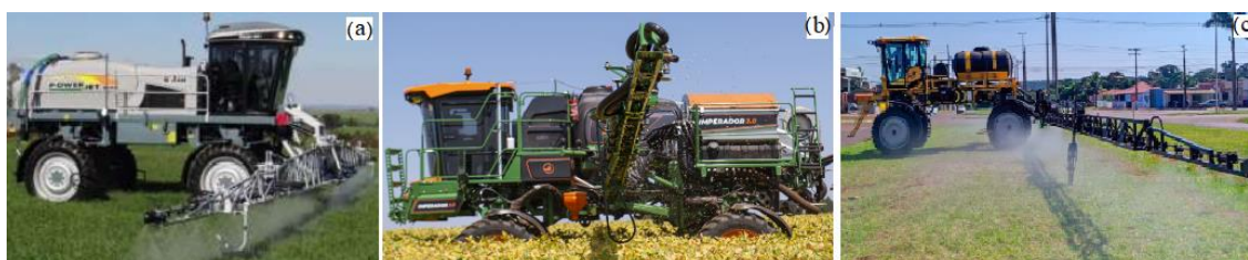
Figura 5 - Posicionamento das barras em autopropelidos: a) Barra frontal; b) Barra Central; c) Barra traseira.
