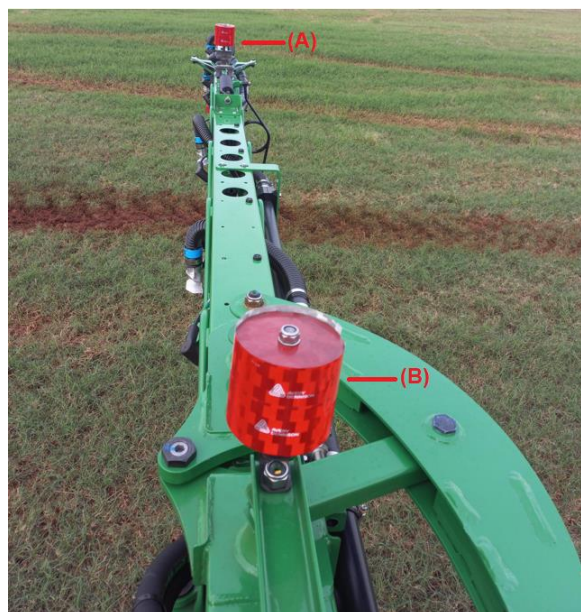
Figura 29 – Pontos de referência instalados sobre a barra de pulverização.
