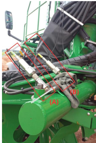
Figura 23 – Instalação dos sensores de pressão hidráulica.
