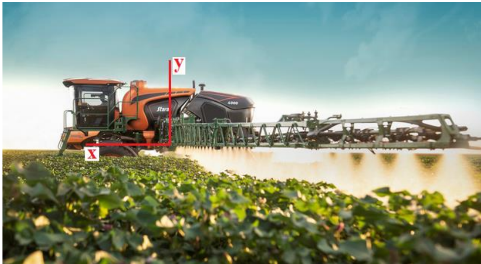
Figura 12 - Sentido de movimento das barras de pulverização.
