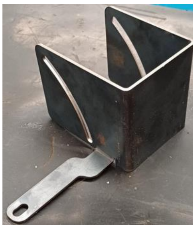
Figura 26 – Ajuste angular para regulagem da posição da câmera fotográfica.
