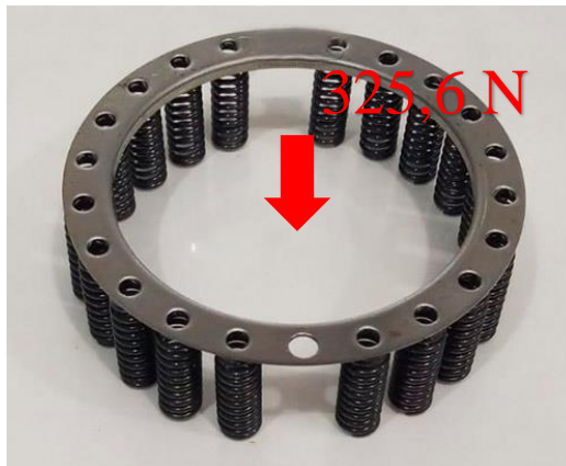
Figura 17 - Cálculos de força aplicada no conjunto da placa de retorno
