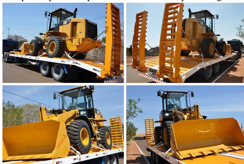
Figura 12 - Carregadeira pronta para transporte em um semirreboque Carrega Tudo.
