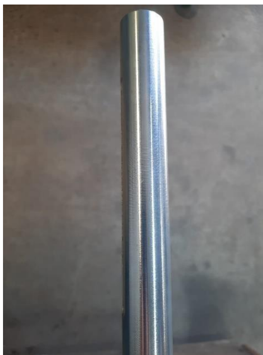
Figura 25 – Conjunto de solda após o processo de zincagem do novo caracol transportador. (Fonte: O autor, 2024)
