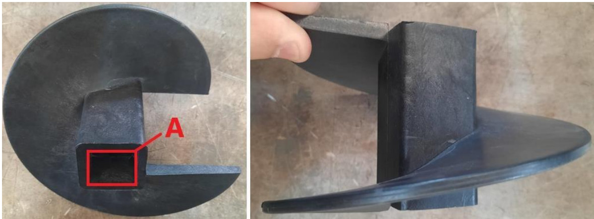
Figura 26 – Helicoide inicial injetado do novo caracol transportador: (A) Cavidade quadrada. (Fonte: O autor, 2024)
