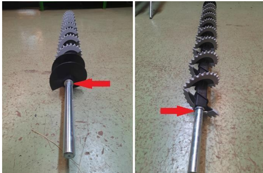
Figura 31 – Montagem finalizada do novo caracol transportador. (Fonte: O autor, 2024)
