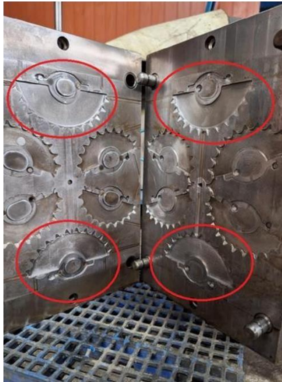
Figura 12 – Molde para injeção: parte externa e interna. (Fonte: O autor, 2023)
