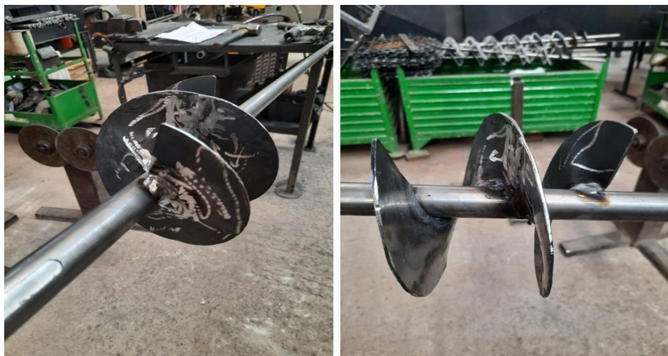
Figura 13 – Soldagem do passo inicial do helicoide. (Fonte: O autor, 2023)
