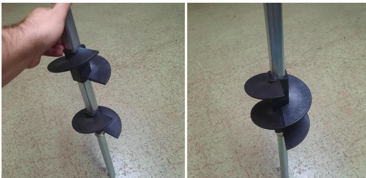
Figura 29 – Montagem do passo inicial do helicoide do novo caracol transportador. (Fonte: O autor, 2024)
