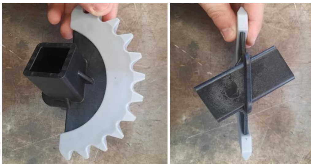
Figura 28 – Helicóide principal injetado de nylon e poliuretano do novo caracol transportador. (Fonte: O autor, 2024)
