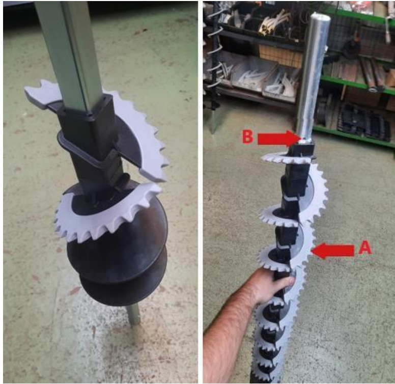
Figura 30 – Montagem do helicoide principal do novo caracol transportador: (A) Helicoide, (B) Furação. (Fonte: O autor, 2024)
