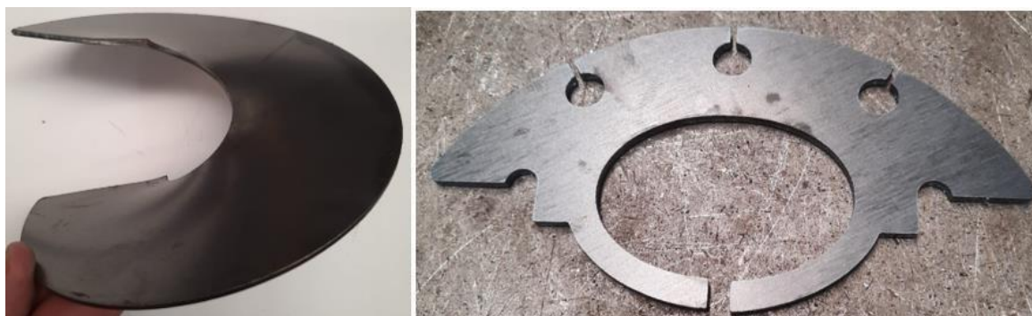
Figura 21 – Passo inicial e peça inicial do helicóide principal. (Fonte: O autor, 2023)
