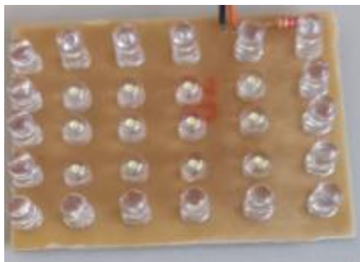
Fotografia 5: Cama de LEDs com saída Vcc e GND
