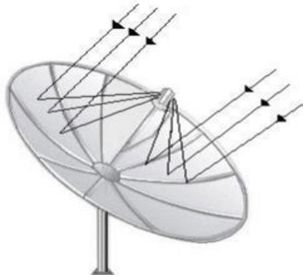
**Esquema de incidência de raios sobre uma Antena Parabólica**
