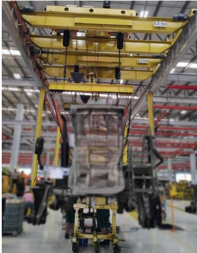
Fotografia 17 – Montagem de componentes no último posto de trabalho
