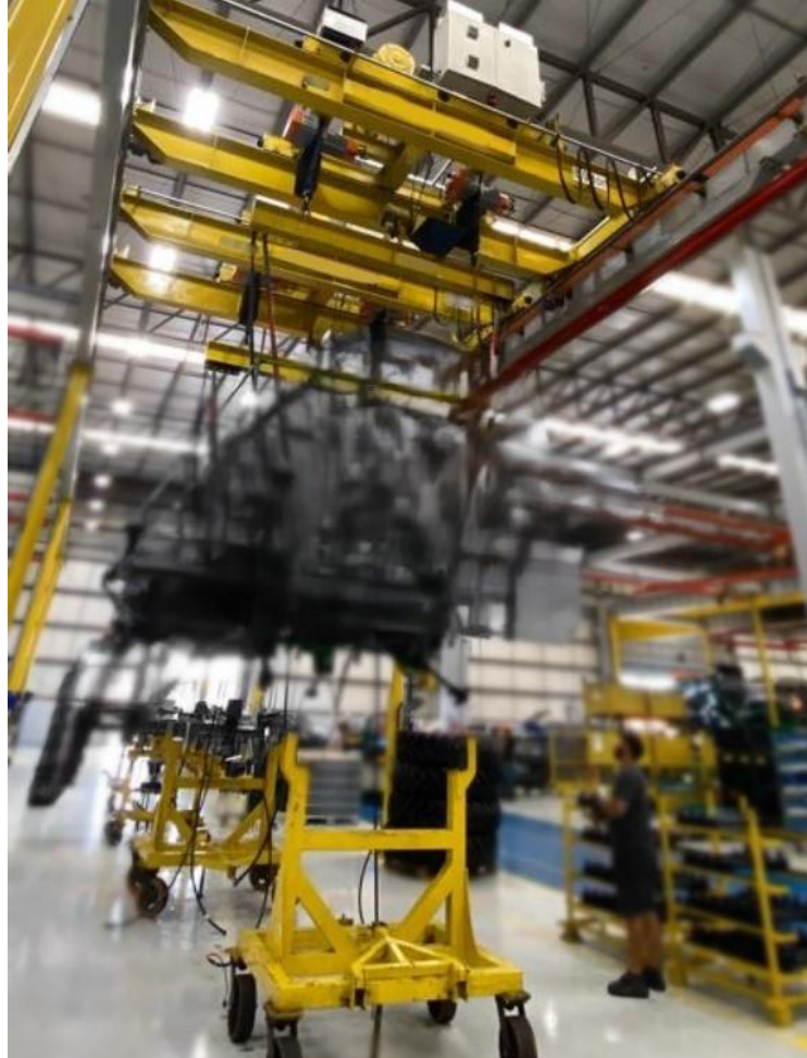
Fotografia 15 – Retirada de produto do dispositivo de montagem
