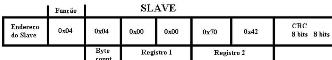
**Figura 3: Mensagem recebida do medidor**
