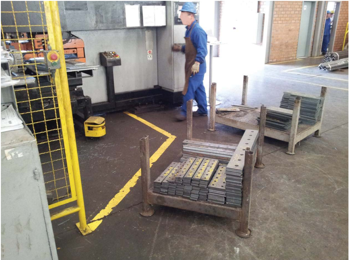
Figura 8: Colaborador da Empresa X furando as peças na maquina para projetos oriundos de retalho Fonte: dados da pesquisa (2013)
