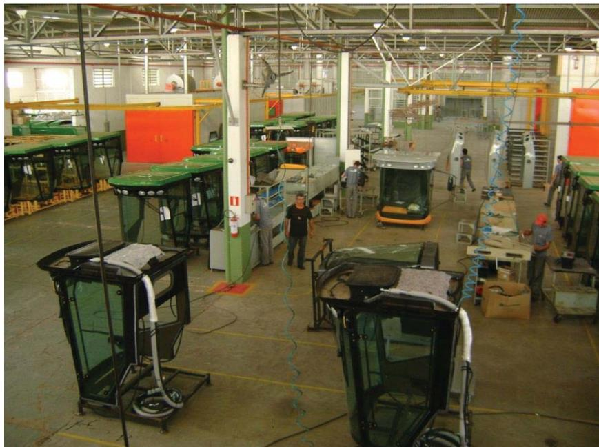
**FIGURA 13 – Processo de montagem das cabines.**
