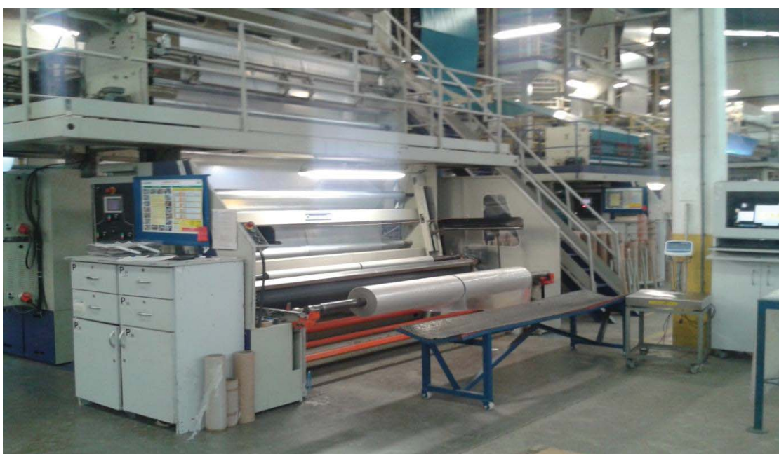
Figura 8- Bobinas de filme plástico da extrusora simples no setor de extrusão da Indústria de Plásticos X Fonte: Indústria de Plásticos X.
