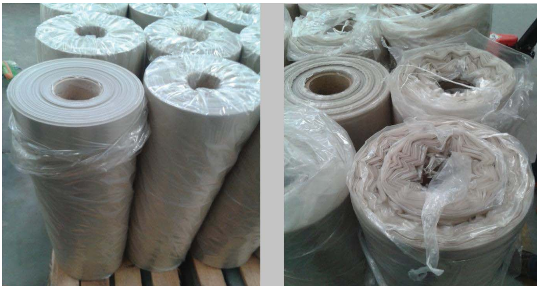
Figura 9- Diferença entre bobinas alinhadas e bobinas desalinhadas Fonte: Indústria de Plásticos X.
