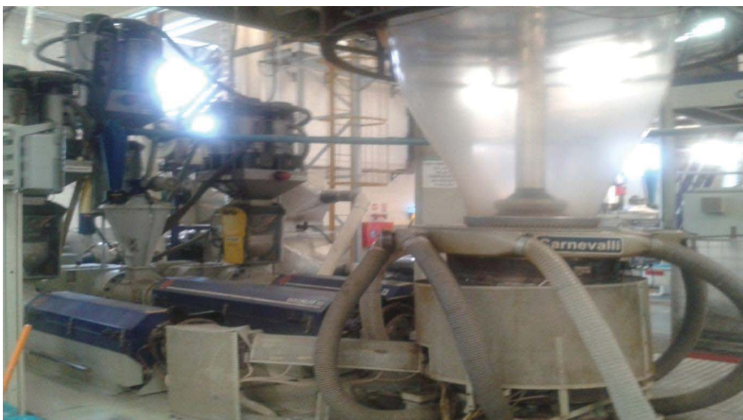
Figura 6 - Coextrusora do setor de extrusão da Indústria de Plásticos X. Fonte: Indústria de Plásticos X.
