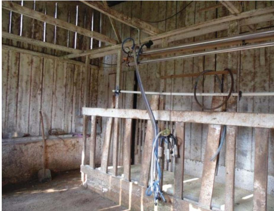
**Figura 10 – Ordenhadeira canalizada existente na propriedade A**
