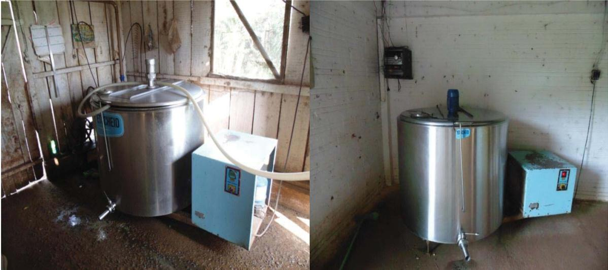
**Figura 6 – Resfriador a granel existente nas propriedades A e C, respectivamente.**
